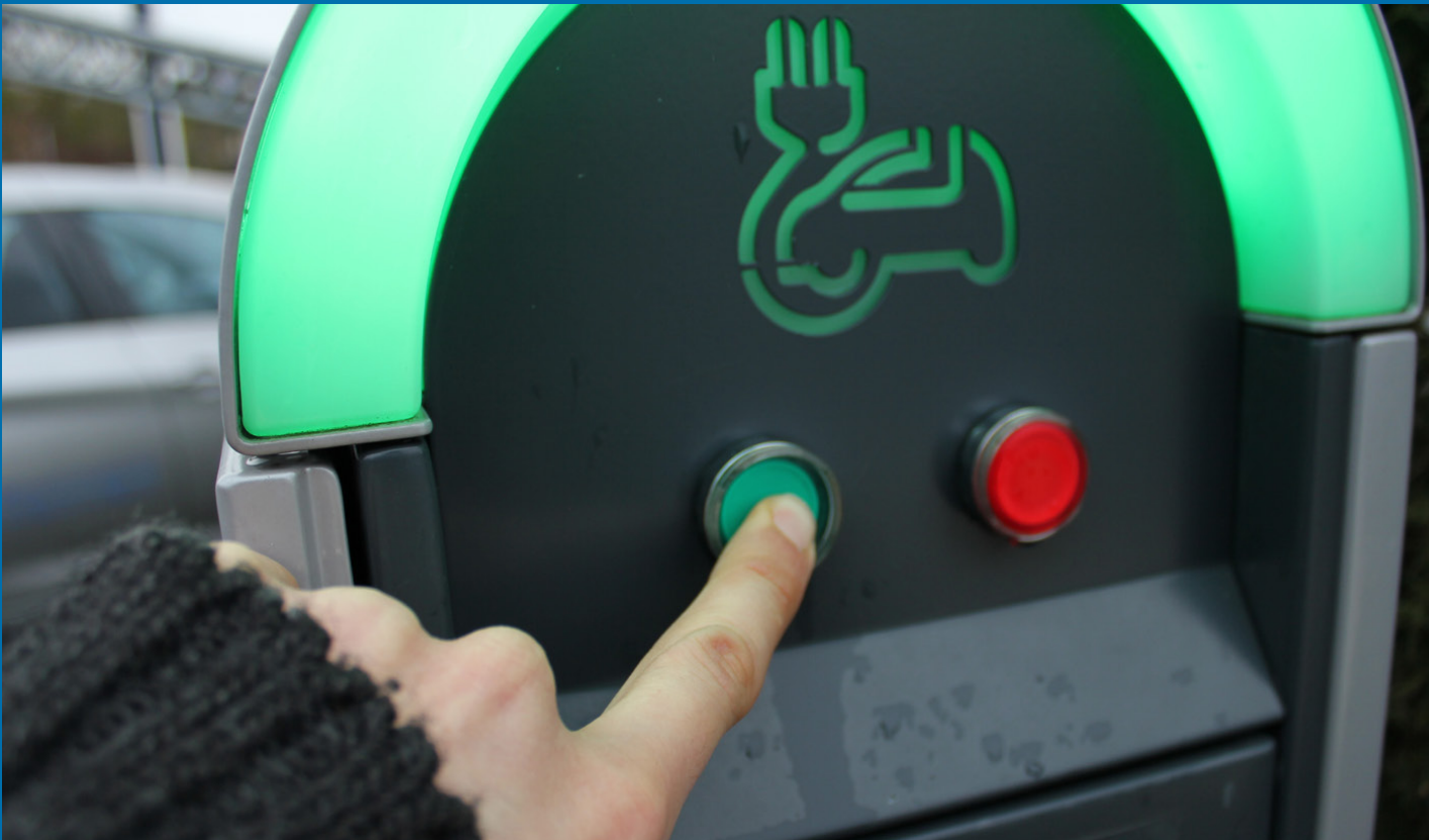
Borne de recharge pour véhicule électrique du réseau Ecocharge77.
